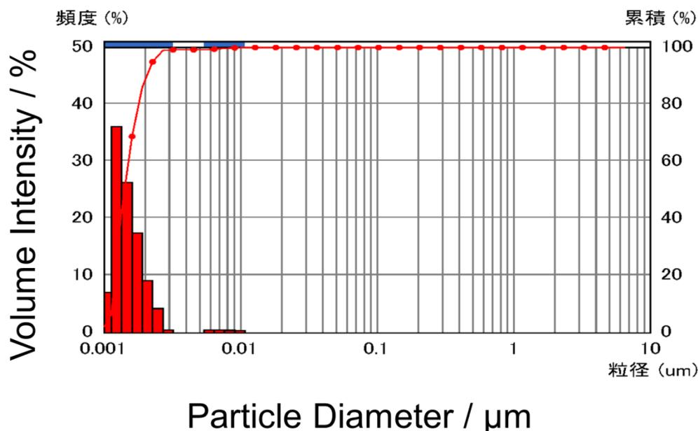
上図は例として酸化セリウム( $\text{CeO}_2$ )のナノ微粒子コロイドの粒度分布図で、溶媒は水です。これらの酸化物ナノ微粒子を基にしたインク、スラリーなども作成は可能です。溶媒は主に水ですが、有機溶剤も要望があれば検討します。例として、下表に  $\text{CeO}_2$  ナノ微粒子(コロイド)水分散体の基礎的な特性を示します。
