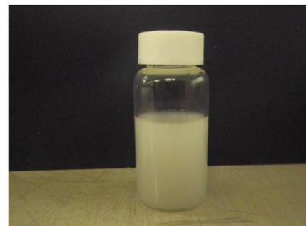
またセルロースナノファイバー(CNF)混合マスターバッチも販売しています。ポリエチレン(PE)、ポリプロピレン(PP)、ポリ塩化ビニル(PVC)、アクリル、ポリエステル樹脂などとの混合マスターバッチです。セルロースナノファイバー濃度は 3-10%ですが、現在さらに高濃度化検討中です。今後、PS、ABS、ポリ乳酸、PBS などの他の樹脂、生分解性樹脂との混合化も検討していきます。
